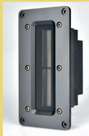
Die Membran des Hochtöners besteht aus einem nur oben und unten aufgehängten Streifen 8 Millimeter breitem Aluminium, der Magnet hinten ist sehr kräftig.
