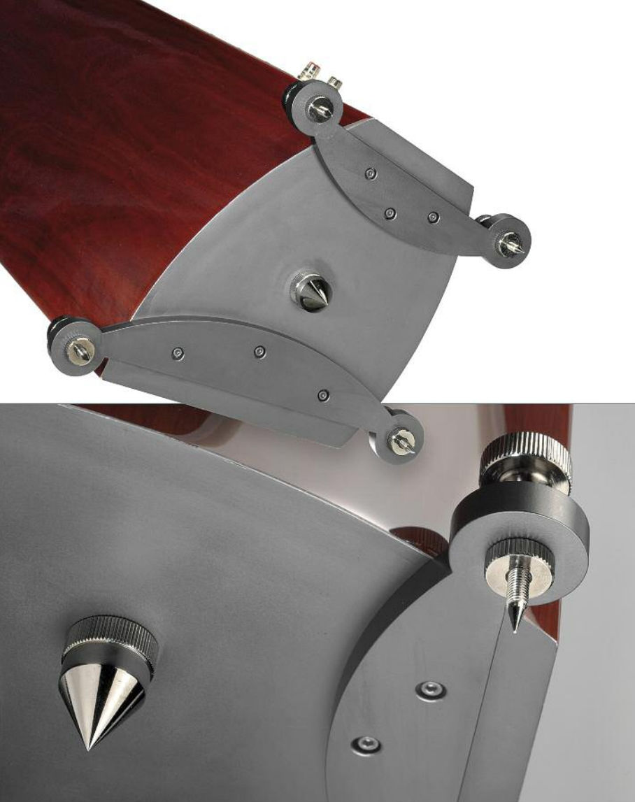
Sauber: Solide Bodenplatte, asymmetrisch angeordnete Spike-Ausleger, mittig sitzendes Kegel-Entkopplungselement zur Ableitung von Körperschall
